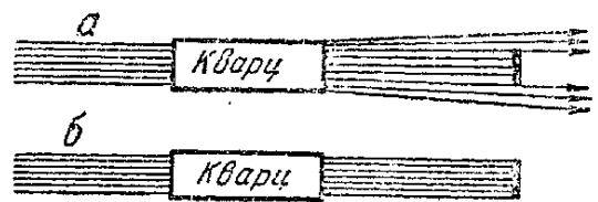
Рис. 14. Диффракция света на стоячей ультразвуковой волне в кварце
